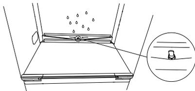
**⚠ Si par inadvertance du lait a été renversé et arrive dans l'écoulement de l'eau de dégivrage:**
